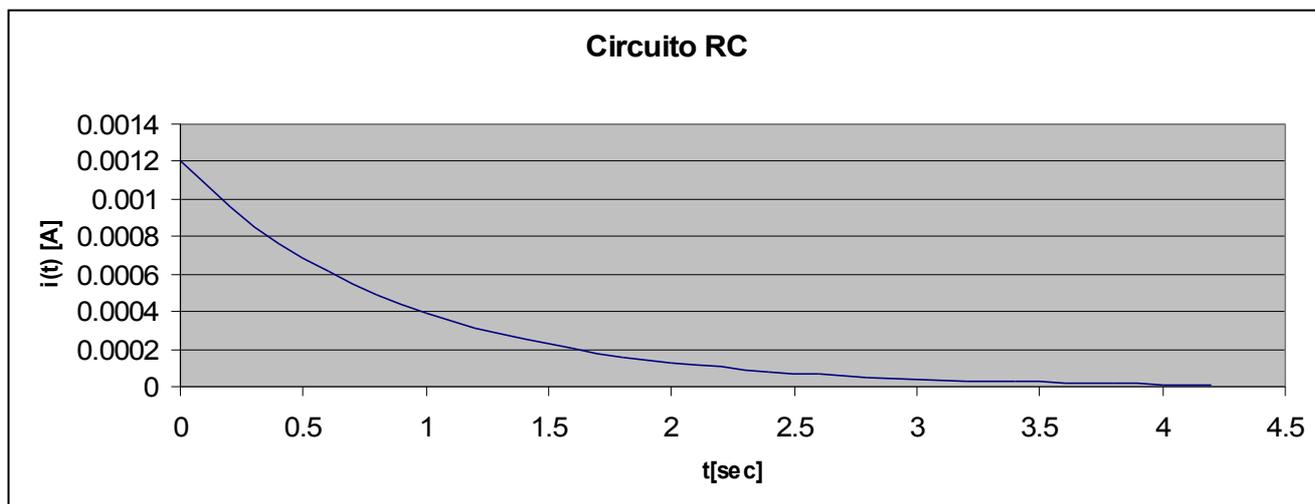
Possiamo ottenere il grafico della tensione  $V_c$  ai capi del condensatore e della corrente  $I$  che circola nel circuito, utilizzando un foglio elettronico.
